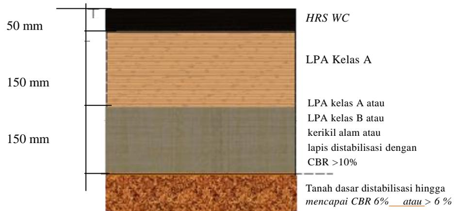
Gambar, 8. Tebal Perkerasan Berdasarkan MDP 2017
